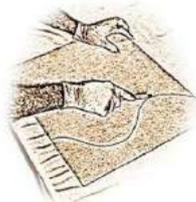
1 Après traçage, découper au cutter la face arrière de la plaque **lamistone** en ligne droite ou en courbe.
