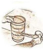
Après avoir abondamment humidifié la face avant, attendre 5 mn. Encoller la face arrière **lamistone** et l'appliquer soigneusement sur le support. Bien appuyer sur toute la surface et enfin, filmer serré pour maintenir le temps du séchage (env. 24h). Diamètre minimum réalisable 10 cm.
