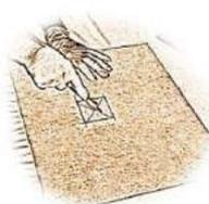
3 Pour les incrustations, découper le long du tracé et les diagonales dans le vide à réaliser.
